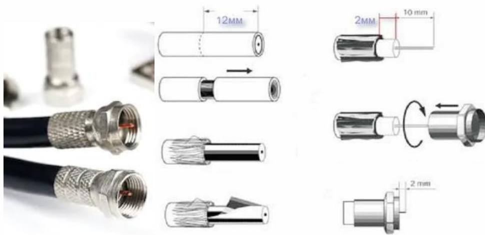
Рис. 6 – Установка F-конектра на коаксиальный кабель.
